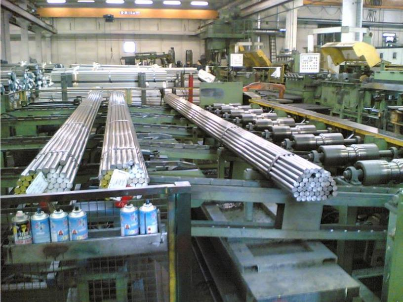
Caratteristica del laminato è la presenza di calamina, ruggine e una superficie grezza con dimensioni grossolane.
